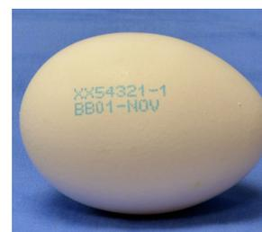
Existem várias abordagens para reduzir o impacto da umidade na qualidade da impressão. Em primeiro lugar, aumente o secador de ovos para remover mais água. O secador é o mecanismo mais eficiente de remoção de água. O aumento do volume de ar ou da distância em que os ovos permanecem sob o secador pode melhorar a secagem. O desafio, porém, é quando o selecionador de ovos fica molhado e a umidade acaba voltando para ovos à medida que eles se movem pelo selecionador.
